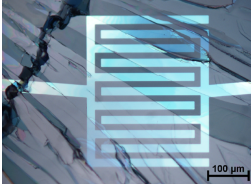
“Cristalli di semiconduttore organico Tips-Pentacene depositato su elettrodi d'oro interdigitati su substrato di quarzo”.
